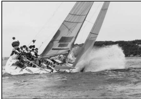
à 5 degrés d'angle de gouvernail sont optimal pour maximiser les performances au prêt. Si vous avez plus d'angle que ça, votre gouvernail créera un trop gros frein. Pour réduire la tension sur la barre, aplatissez vos voiles,
