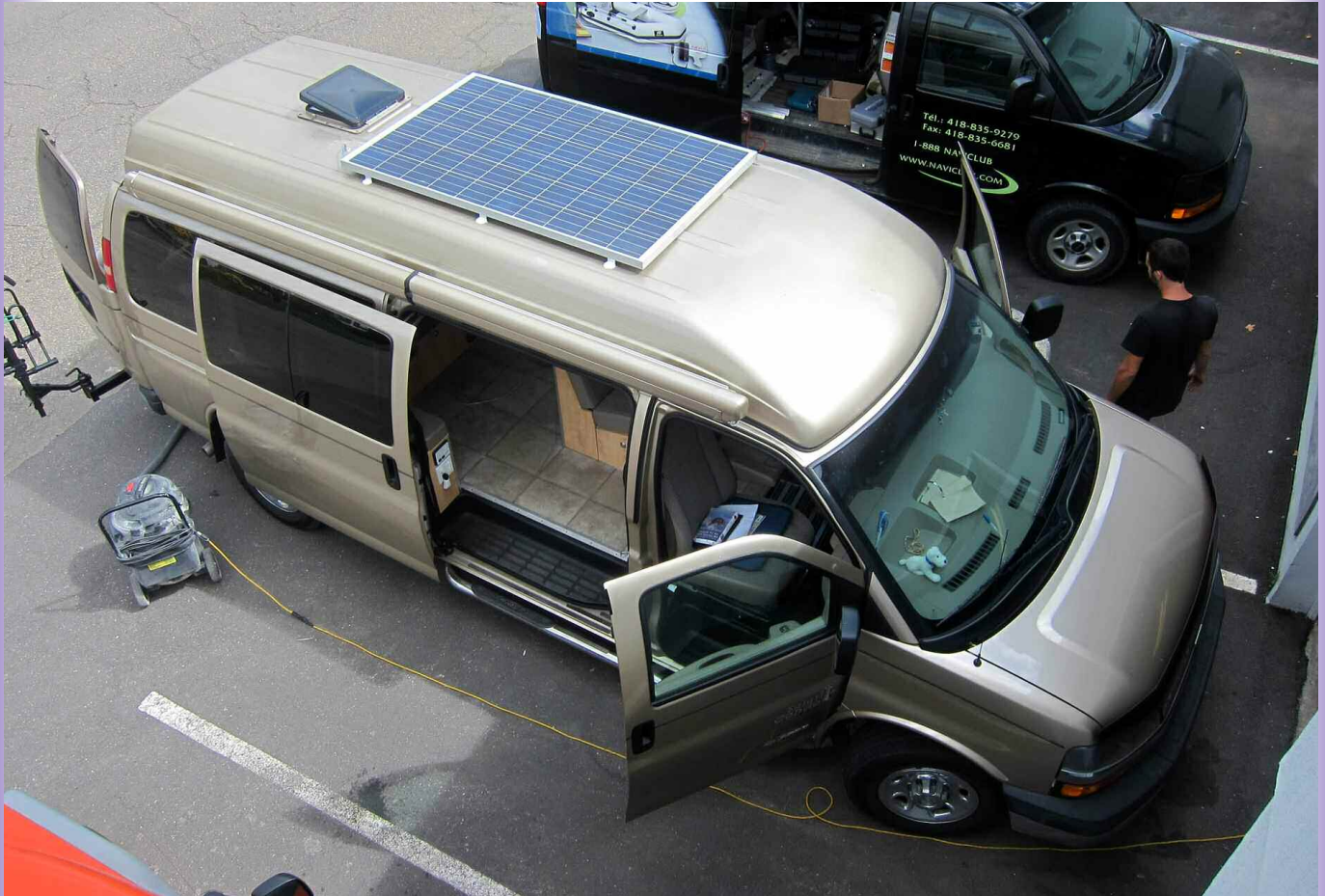
Un panneau solaire de 245 watts sur un Safari Condo
